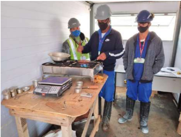
Foto 3 – Trabalhadores seguem as orientações do engenheiro para checar o grau de compactação da terra em laboratório. Data: (29/06/2021).
