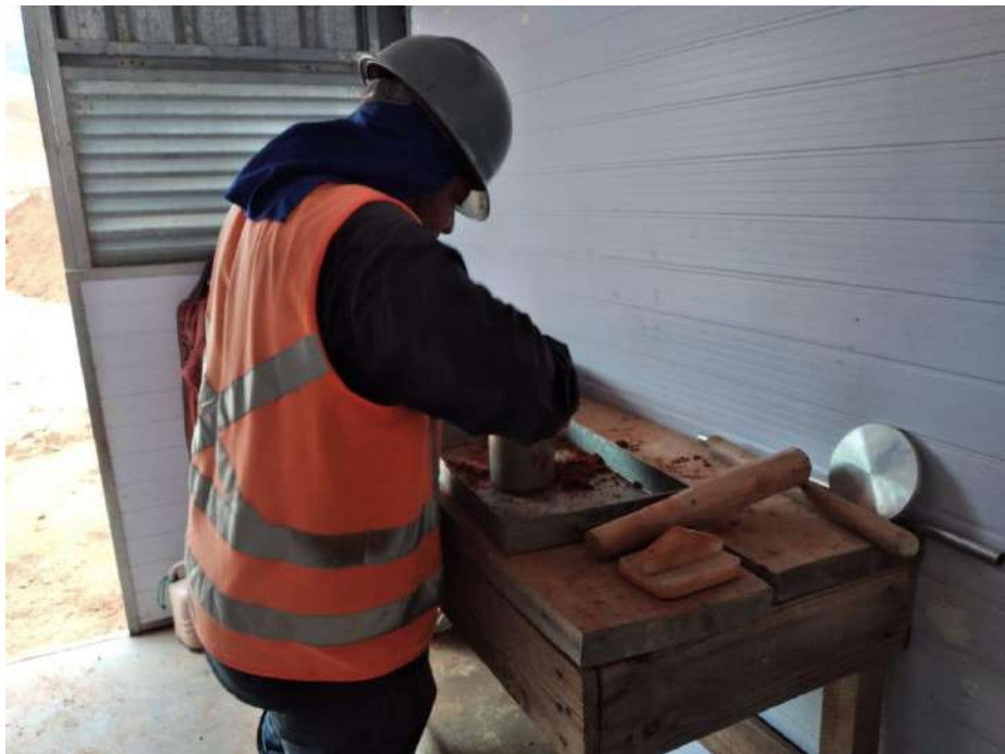
Terra captada de uma das camadas do aterro experimental já no laboratório para mais uma medição de grau de compactação
